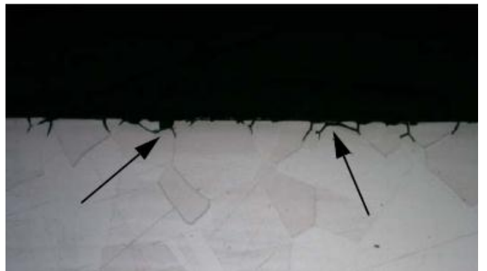
图 3：截面分析所示的晶间腐蚀
